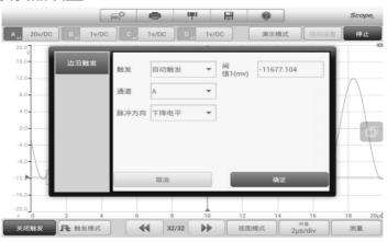
**触发**:用于过滤和捕获指定的波形数据。
