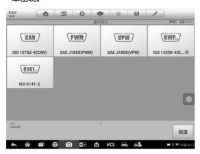
图 4-14 "OBD II 诊断菜单"示图
