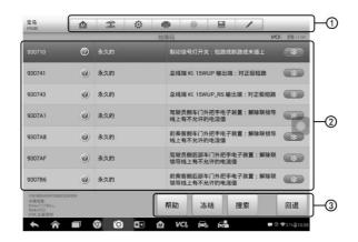
图 4-9 "读故障码"界面示图
