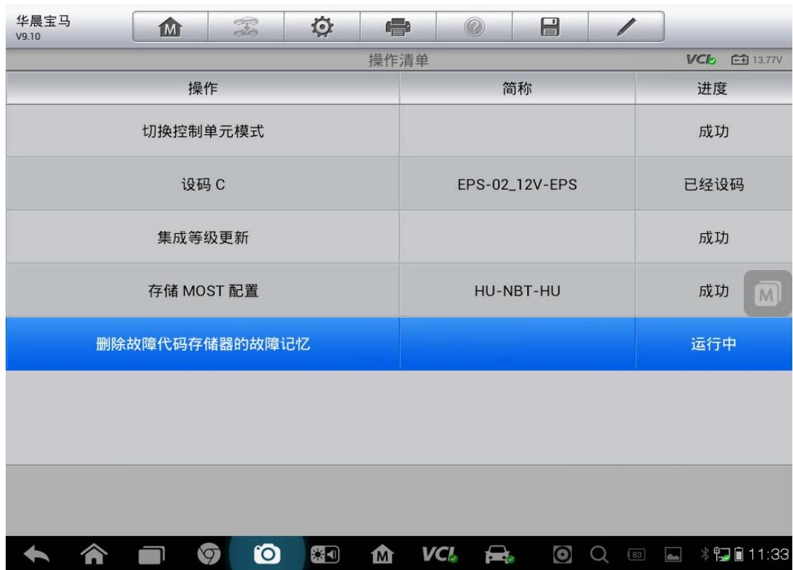
5. 进度条读取完成后，点击“确定”，完成设码
