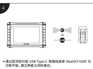
MaxiVCI V200 与诊断平板成功连接后,诊断平板底部 VCI 状态按钮的右下角会显示一个绿色标识,表示设备已准备就绪,可随时开始车辆诊断。
