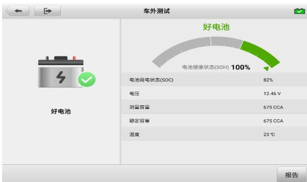
图 12-10 “电池检测结果”界面示意图
