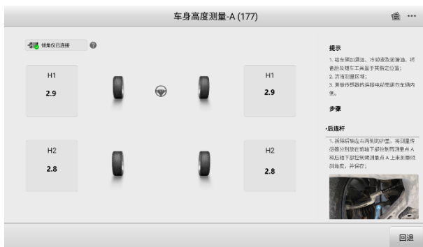
图 14-3 车身高度测量结果示图
